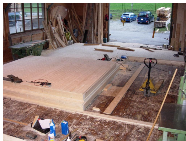
Réalisation des caissons bois en atelier
